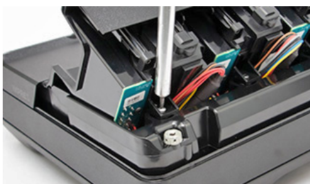
Figure 26 : Retrait de la vis de l'adaptateur de logement
