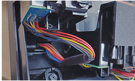
Figure 28 : Retrait du câble pour chaque adaptateur de logement
