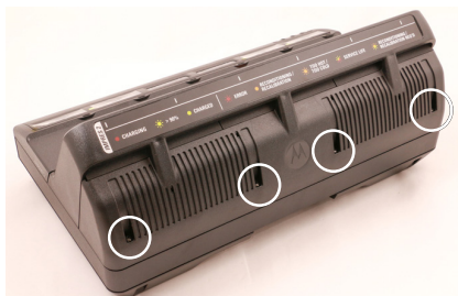
Figura 32: Instalação dos parafusos da tampa superior
