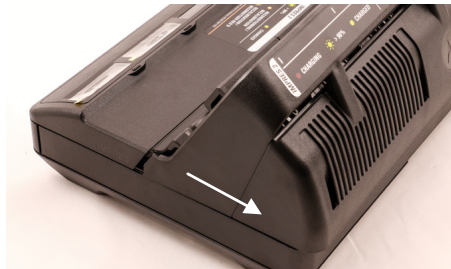
Figura 26: Remoção do parafuso do encaixe de compartimento
