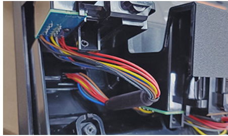
Figura 28: Remoção do cabo de cada encaixe de compartimento
