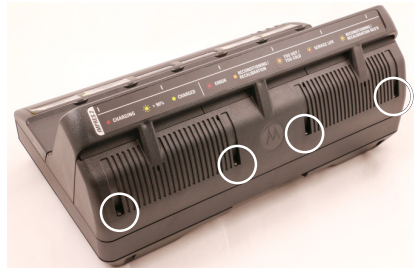
Figura 24: Os quatro parafusos na proteção traseira
