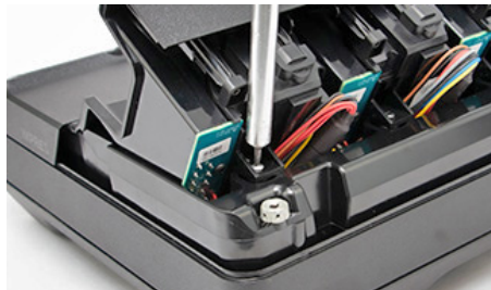
Figura 26: Remoção do parafuso do encaixe de compartimento
