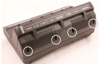
Figure 32 : Pose des vis du protecteur de contact
